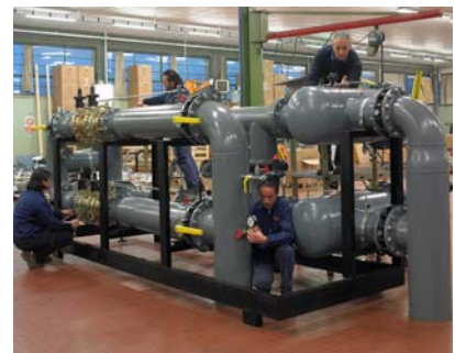
Emerson 设计和制造了天然气调压系统，将保持圣火在冬奥会全程长燃不熄。
